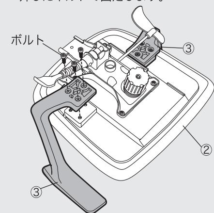
4 ①背もたれを図のように②座面裏面のプレートに差し込み、穴位置を合わせ、⑨背座つまみにワッシャーを付けて時計回りにつまみを回し②座面と①背もたれをしっかりと固定する。
