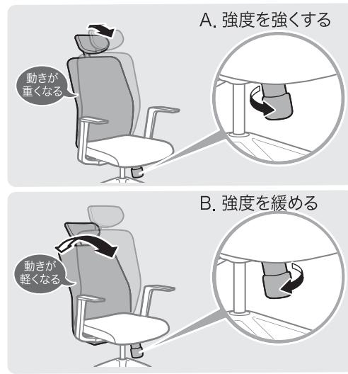
座面の下の背もたれ傾き強度調節キャップを左右に回すことで緩みの調節ができます。
